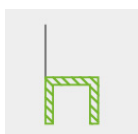
TELAIO (4P) In tubo semiovale 30x15 verniciato epossidico nero
